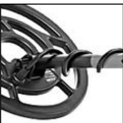
Аккуратно обмотайте провод поисковой катушки вокруг штанги, сделав первый виток поверх штанги. При достаточно плотной намотке кабель не должен мешать изменению угла наклона катушки.
