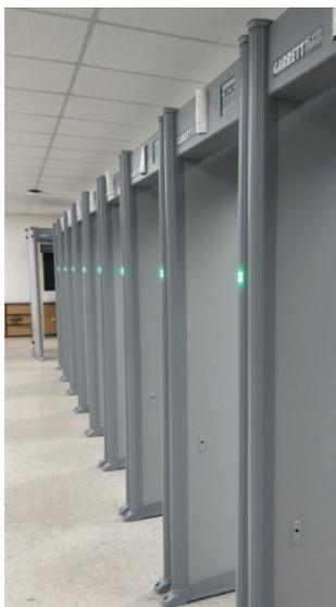
Применяемая в модели импульсно-индукционная технология обнаружения позволяет исключить взаимную маскировку предметов с противоположными магнитными свойствами, производить автоматический выбор оптимальной рабочей частоты в зависимости от окружающей электромагнитной обстановки для отстройки от помех, и устанавливать несколько металлодетекторов рядом друг с другом на расстоянии в 5 см.
