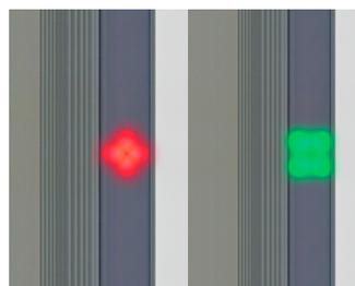
Зеленый и красный индикаторы светофора прохода, высокой яркости, расположены на уровне глаз, на торцевой части панели металлодетектора.
