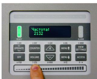
Благодаря интуитивному меню и удобному доступу к регулировкам с использованием слайдера прокрутки клавиатуры, настройка металлодетектора оператором чрезвычайно проста. 32-х символьный дисплей позволяет легко выполнить навигацию по меню.
