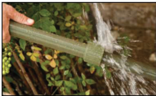
Чистой водой промойте штангу и фиксирующие, чтобы смыть грязь, соль и т. п.
