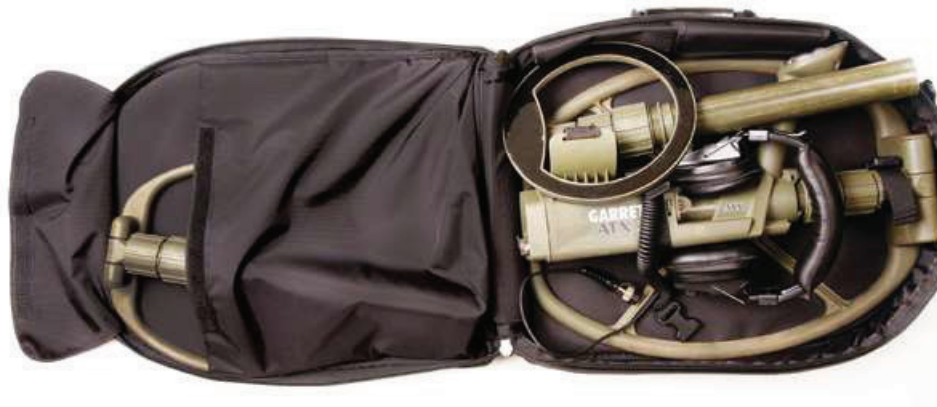
Рисунок 6: АТХ с подсоединённой катушкой Deerseeker + катушка DD + катушка 8" topo + наушники. Примечание: Чтобы катушка DD не выпадала, закройте карман на «липучку».
