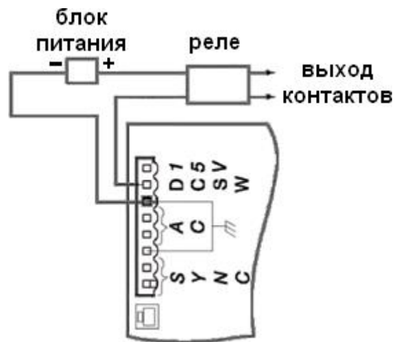
Вариант 2. Реле подключено к контроллеру через внешний блок питания
