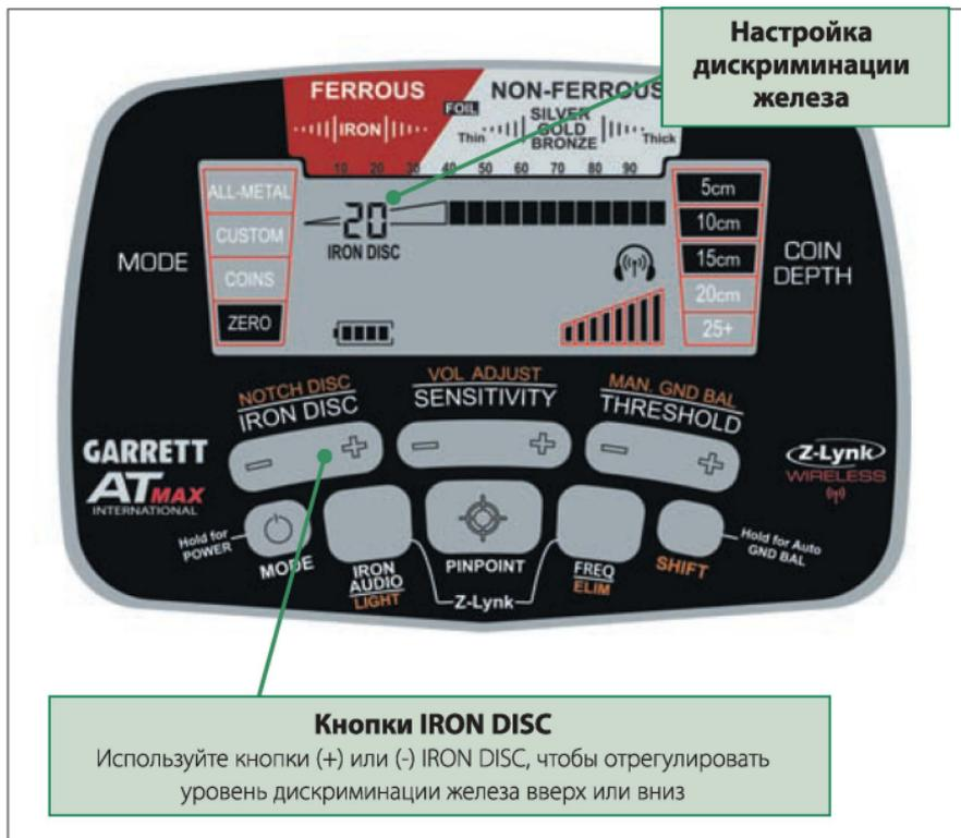
**Маскирование железа:** Чтобы предотвратить «маскирование» железным объектом сигнала соседней цели, используйте достаточную дискриминацию, чтобы просто отклонить железный мусор (например, небольшой гвоздь, как показано на иллюстрации 1). Это позволит обнаружить монеты и гвоздь вместе (см. иллюстрацию 2), а не пропустить / замаскировать хорошую цель.
