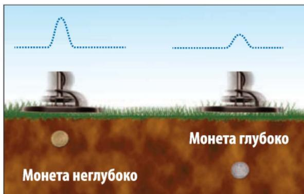
Пример В: Обратите внимание на различный отклик, предоставляемый пропорциональным звуком *AT Max* относительно глубины цели.
