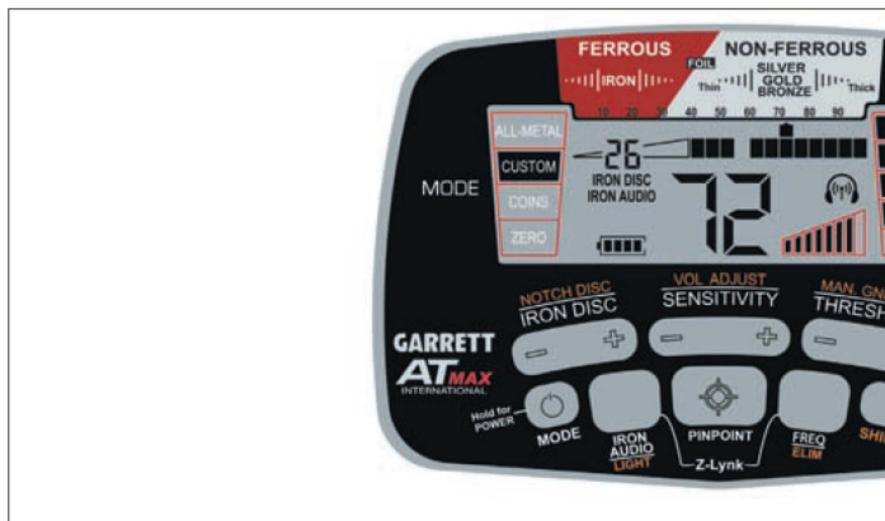
Нажмите и отпустите кнопку IRON AUDIO для включения / выключения функции Iron Audio. Когда эта функция включена, слова «IRON AUDIO» появляются на ЖК-дисплее (как показано на рисунке выше). Функция Iron Audio может использоваться в любом из четырех режимов AT Max. Его функциональные возможности в трех режимах дискриминации по сравнению с режимом All Metal будут обсуждаться отдельно.
