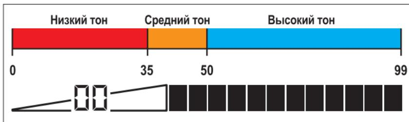
IRON AUDIO **ВЫКЛ.**: Нормальное деление низких, средних и высоких тонов в режиме различения.
