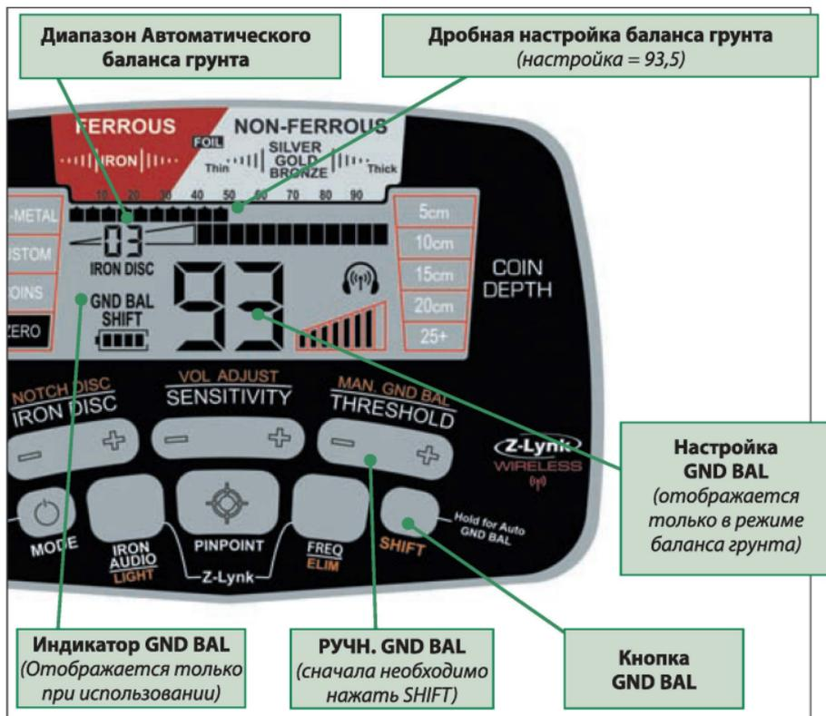
**Кнопка GND** — Удерживайте кнопку SHIFT для автоматического баланса грунта. Для ручной балансировки грунта, нажмите и отпустите кнопку SHIFT, а затем используйте кнопки (+) и (-) MAN. GND BAL.
