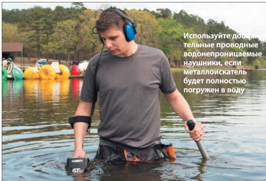
Используйте дополнительные проводные водонепроницаемые наушники, если металлоискатель будет полностью погружен в воду
