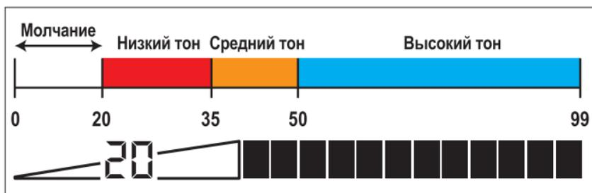
IRON AUDIO **ВЫКЛ.**: При наличии дискриминации железа, установленного на 20, все цели ниже 20 не будут выдавать никакого звукового сигнала.
