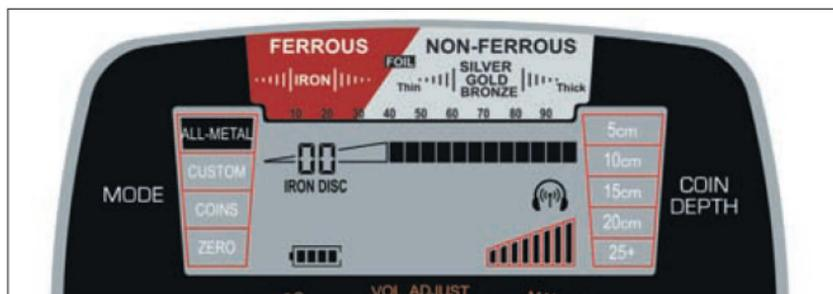
В режиме ALL METAL AT Max реагирует на весь диапазон проводимости и магнитных свойств, включая отклики от грунта. Пользователь постоянно слышит, что поисковая катушка «видит» в земле. Поэтому для правильной работы в режиме ALL METAL необходимо правильно настроить баланс грунта. Встречающиеся естественные минералы в почве должны быть учтены во время процедуры баланса земли, чтобы обнаруживать только сигналы от металлических предметов.
