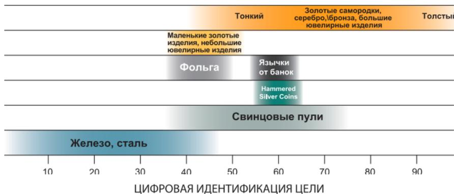
Цифровое значение ID цели может широко варьироваться в зависимости от размера и толщины цели, поскольку небольшие тонкие куски металла не могут проводить электрический ток так же, как более толстые куски металла. Кроме того, минерализованные почвы могут вызывать ошибки ID цели, особенно для небольших целей.
