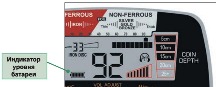
Четыре сегмента показывают полностью заряженную батарею. Замените батареи, когда остается только один сегмент. Детектор будет иметь полную работоспособность до тех пор, пока батареи не будут требовать замены. Допускается использование аккумуляторов NiMH, но они могут иметь более короткий срок службы. Можно ожидать 15-25 часов работы без беспроводных наушников и 10-20 часов с беспроводными наушниками в зависимости от типа и качества батарей.
