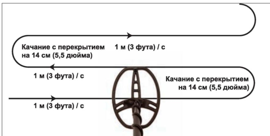
Чтобы полностью выполнить поиск в области, выполните перемещение поисковой катушки с перекрытием на половину длины катушки (около 14 см). Проводите поисковую катушку по прямой или с небольшой дугой со скоростью перемещения около 1 м / с.
