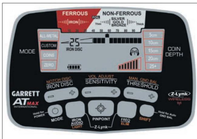
Примечание: Изменения, внесенные в шаблон меток дискриминации в режиме CUSTOM, будут сохраняться при отключении питания металлоискателя. Изменения, сделанные во всех других режимах, вернуться к заводским настройкам, когда металлоискатель выключен и снова включен.
