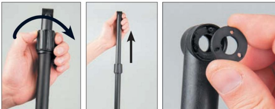
Подключите поисковую катушку к штанге, как показано на рисунке, и затяните руками барашковую гайку. Ослабьте верхний эксцентриковый зажим, нажмите на пружинный фиксатор в S-образной штанге и вставьте среднюю штангу в S-образную штангу. Затяните эксцентриковый фиксатор.
