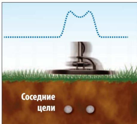
Пример А: Соседние цели часто могут генерировать единый сильный сигнал во многих металлоискателях. Однако быстрое восстановление процессора *AT Max* обеспечит два пика звуковой реакции на эти соседние монеты. Эти множественные звуковые ответы предоставляют опытному пользователю больше информации о цели.
